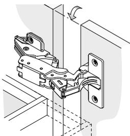
Нулевое входение для применения на внутренних выдвигаемых элементах.
